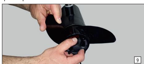
Po každom používaní motora treba skontrolovať hnaciu skrutku so zameraním na prítomnosť zapletených silónov alebo vodných rastlín a v prípade potreby ich treba odstrániť.
