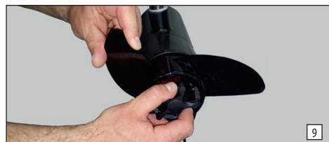
Het plaatsen gebeurt in omgekeerde volgorde. Wanneer je een nieuwe propeller plaatst, verzeker je er dan van dat borgpen en gleuf passen zoals bedoeld is, anders kan de propeller niet goed aangebracht worden. Check de propeller telkens na gebruik op lijnen of waterplanten die zich vastgezet hebben en verwijder deze indien nodig.
